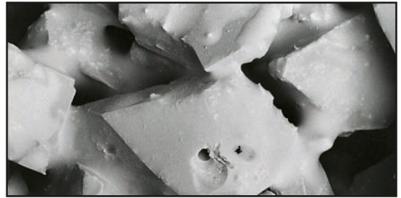
De afbeelding toont een keramische CBN-slijpkorrel met een poreuze structuur
